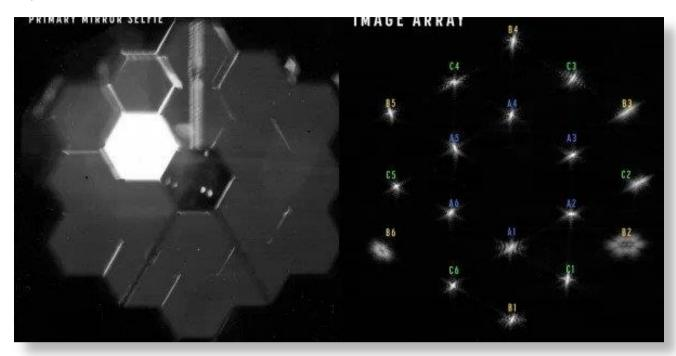
Entonces comenzó el proceso de alineación de los 18 (!) espejos, cada uno con 6 caras. Luego se tomó la siguiente foto final para evaluar los resultados de la alineación de los 18 espejos del telescopio.
